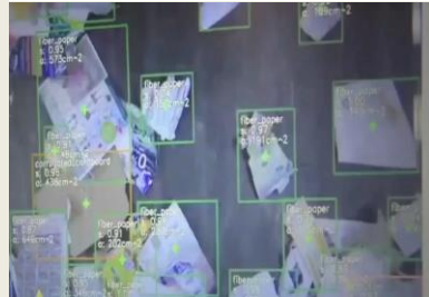
Роботизированная, конвейерная сортировка при помощи машинного зрения и пневмозахвата
