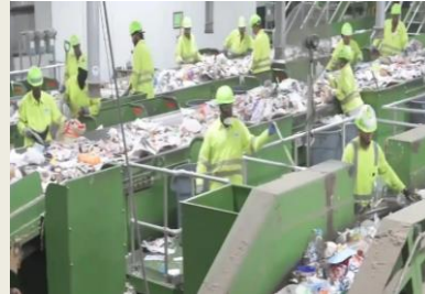
Конвейерная заводская сортировка с применением ручного труда
